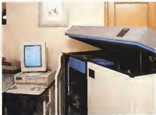
È così il sistema EDMS «in view» basato su PC MS-DOS connesso ad un juke box.
